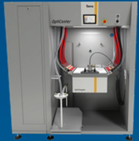
OptiCenter OC09 con quadro di comando pistole sul lato sinistro
