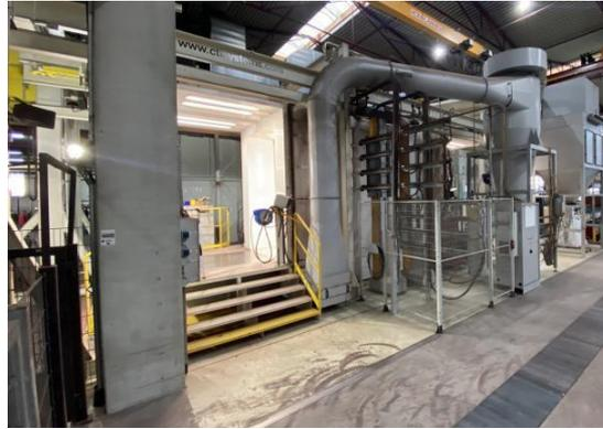
Pulverbeschichtungsanlage mit 3D-Scanner und dynamischer Konturerkennung in Betrieb.
