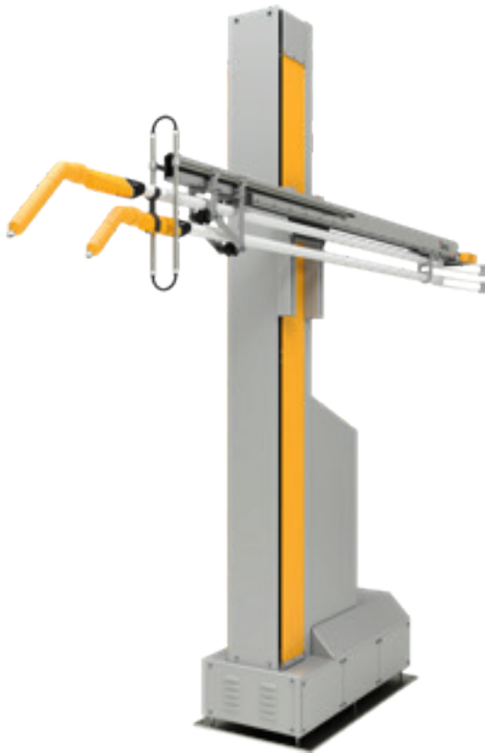
Axe multi-pistolets UA05-2 avec 2 pistolets et anneau de soufflage
