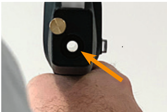
Contrôle visuel de l'ensemble du tube de poudre
