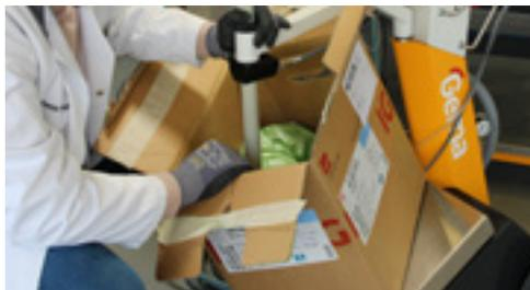
Schritt 6: Ansaugrohr in neue Farbe absenken
