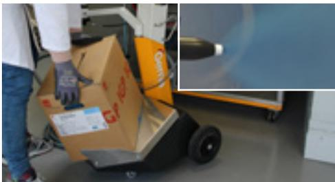
Schritt 5: während automatischer Reinigung den Pulverkarton wechseln
