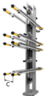
Montaggio massimo: fino a tre moduli ZA17 uno sopra l'altro su entrambi i lati dello ZS05 con distanza tra le pistole di 350 mm (C)
