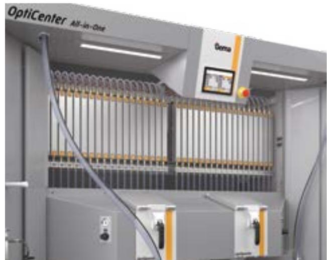
Platzsparend integrierte Applikationspumpen sorgen für eine nahtlose Interaktion zwischen pneumatischen und elektrostatischen Funktionen.
