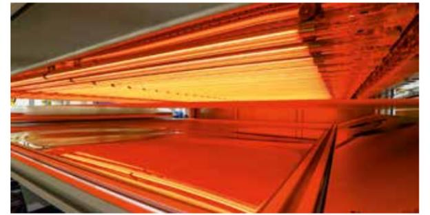
Für die Trocknung sind 24 schnelle mittelwellige Infrarot-Strahler installiert, die in Fischgrätenform über die Bahn verteilt sind.
