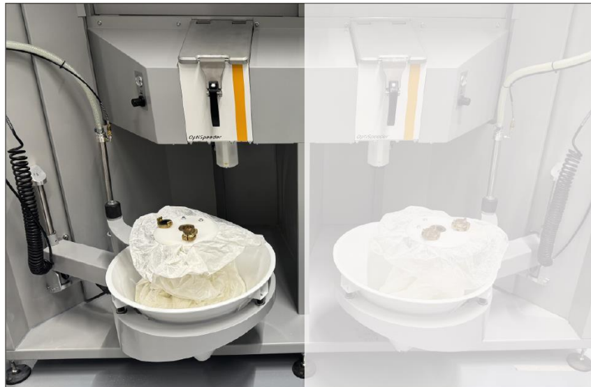
Abb. 96: Frischpulver platzieren Arbeitsbereich 1
